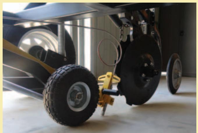
FIGURE 3: THE AQUA-TILL ULTRA-HIGH-PRESSURE LIQUID CUTTING NOZZLE FITTED TO A PARALLELOGRAM SYSTEM IS TO BE TESTED AS A LIQUID COULTER IN 2015.
