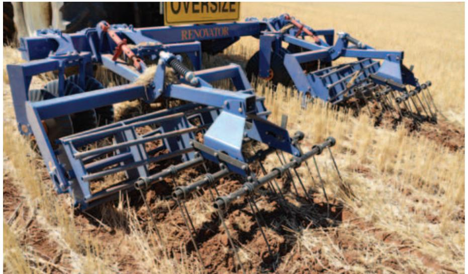
SOIL PULLED ONTO THE WHEEL TRACKS BY THE RENOVATOR'S DISCS IS FIRMED BY ROLLING HARROWS AND LEVELLED BY BY TRAILING FINGER HARROWS.
